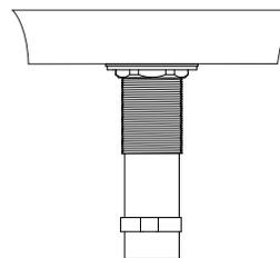
1. Introduzca la contra (no incluida) a través del barreno del mueble, e instálela de acuerdo a las instrucciones de instalación del producto. Coloque la tuerca a través del tubo de la contra.
