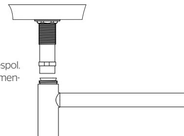
3.- Pase a través del tubo de descarga el chapetón y, conecte el tubo a la entrada de descarga de agua. Alinee el tubo de descarga de forma tal que quede instalado horizontalmente o ligeramente inclinado para ayudar a que fluya el agua libremente.
