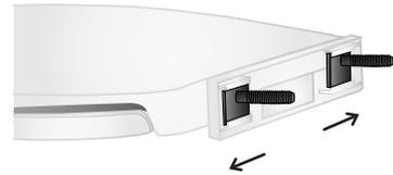
B) Introduzca el tornillo en el gozne y en el barreno de la cerámica y coloque la tuerca.
